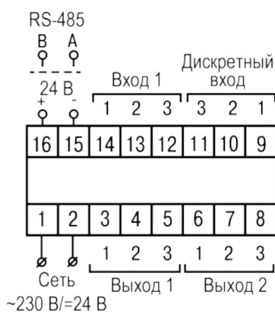
Рисунок 5.5 – Общая схема подключения TRM10–Щ5
